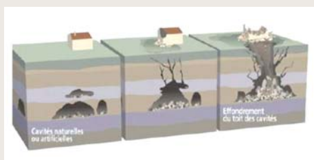
Schématisme de l'évolution d'un fontis
