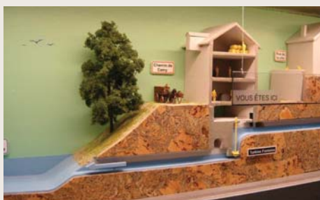
Le moulin B. Montagne, sa prise d'eau et sa galerie d'amenée
